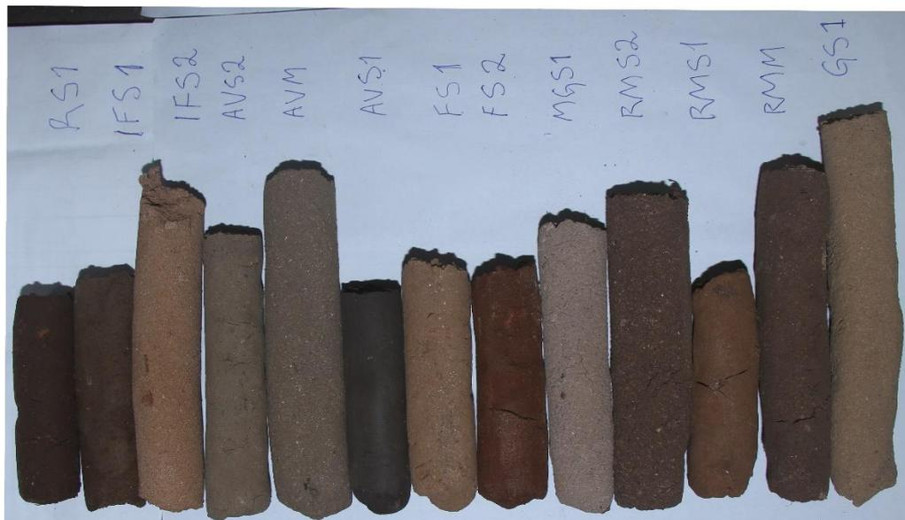
Figura 20: pedaços de rolos secos, sobras do ensaio do rolo e usados para verificação de fissuras de retração.
