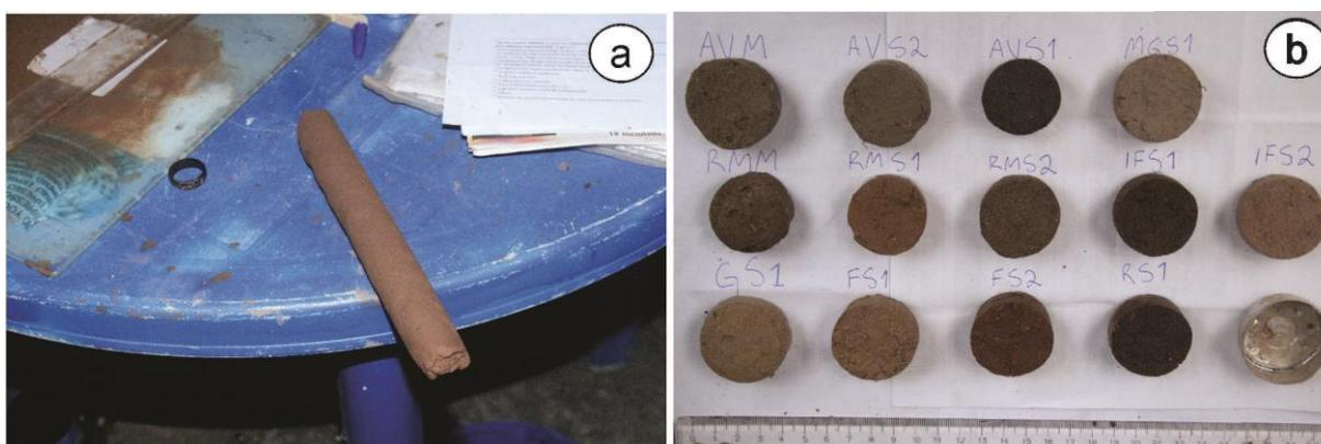
Figura 14: Ensaios de campo. a: ensaio do rolo; b: ensaio de resistência seca após secagem de todas amostras.
