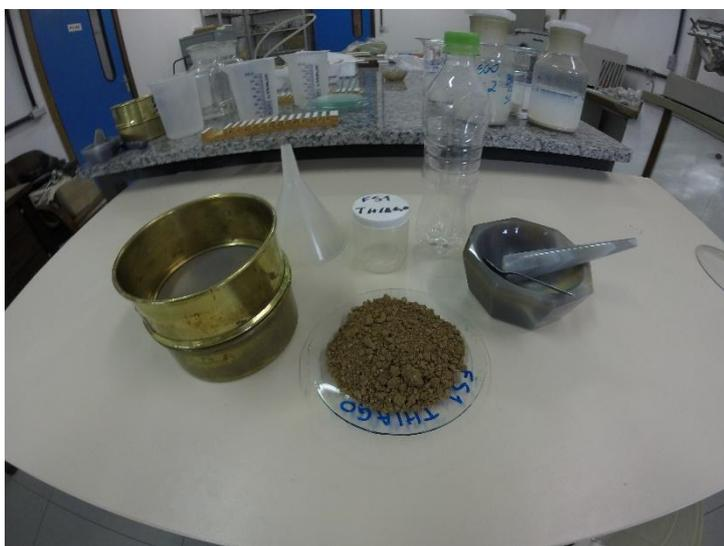
Figura 10: ferramentas utilizadas na preparação de amostras para análise de solo total.
