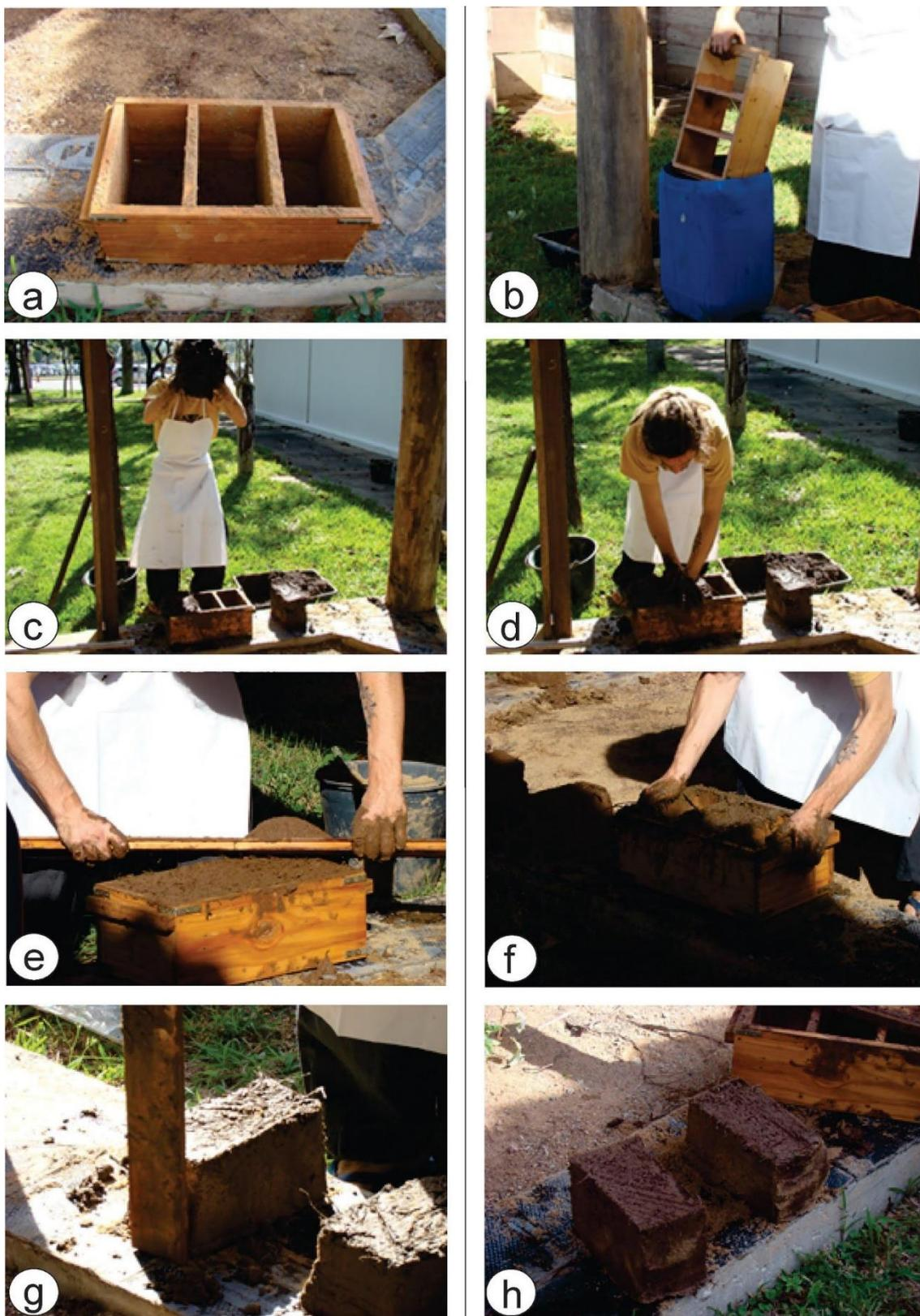
Figura 9: etapas de produção de adobe. a: forma de madeira utilizada, molhada e com areia, pronta para receber mistura de terra; b: forma sendo molhada em tonel com água; c e d: lançamento de mistura de terra sobre forma mostrando técnica; e: régua de madeira retirando excesso de material; f: retirada da forma, desgrudando adobes; g: correção de imperfeições; h: adobes finalizados.
